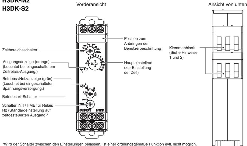
Hinweis 1. Verwenden Sie für den Anschluss an die Klemmen Volldraht (max. 2,5 mm<sup>2</sup>) oder Aderendhülsen mit Isolierungen. Damit nach dem Anschluss an die Klemmen die Spannungsfestigkeit erhalten bleibt, führen Sie nicht mehr als 8 mm des abisolierten Leiters in die Klemme ein.
