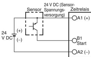
Schaltet, wenn der PNP-Transistor auf EIN geschaltet wird.
