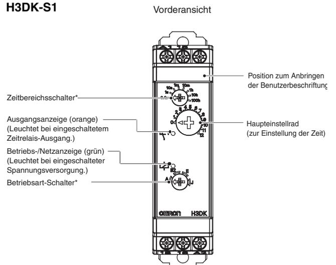
\*Wird der Schalter zwischen den Einstellungen belassen, ist einer ordnungsgemäße Funktion evtl. nicht möglich. Achten Sie auf die richtige Einstellung des Schalters.
