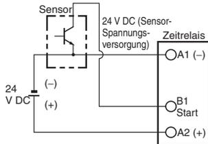
Schaltet, wenn der NPN-Transistor auf EIN geschaltet wird.
